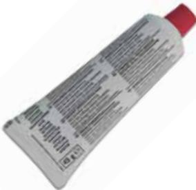
Endurecedor específico para masillas de poliéster MASTIK PRO y MASTIK CAR a base de peróxido de benzoilo. Mezclar bien hasta que la pasta tenga un color uniforme. Remover cuidadosamente a fin de no incorporar aire. Excesiva cantidad de endurecedor puede causar emblanquecimiento del acabado. Usar sólo la cantidad necesaria, 2 partes sobre 100.
